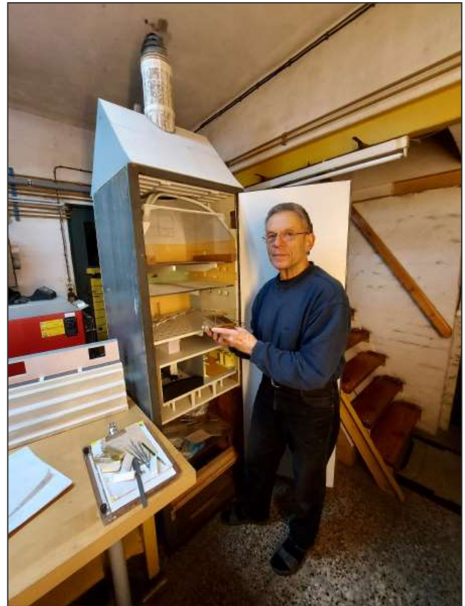
Arbeitsspindel der Mälzerei mit Einbauten
